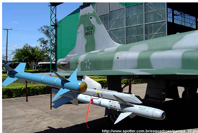
Fig. 1. Aeronave F-5M configurada com mísseis (MAA-1 e Python 3).
