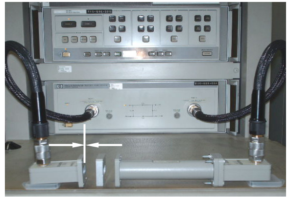
Fig. 3. Configuração para medidas dos parâmetros S [2,5].
