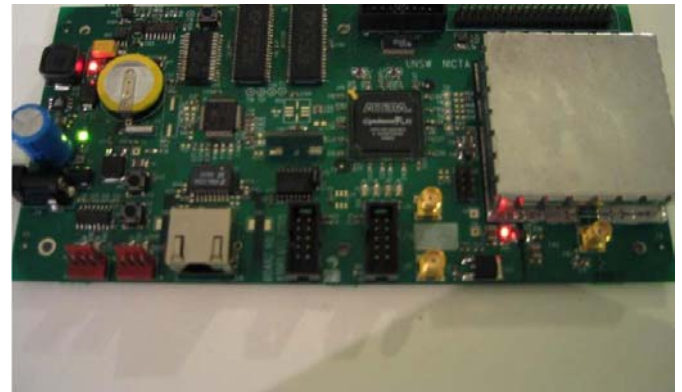
Fig. 11 – Protótipo receptor GPS empregando FPGA. [8]
