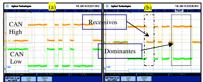
Fig. 5 (a): Sinais no CAN_H e no CAN_L e (b) representação dos bits recessivos e dominantes do CAN
