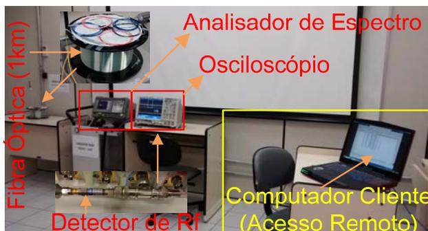
Fig. 11. Foto do arranjo experimental remoto montado para avaliação dos sinais radar, distante do gerador de sinais Excalibur DRS.
