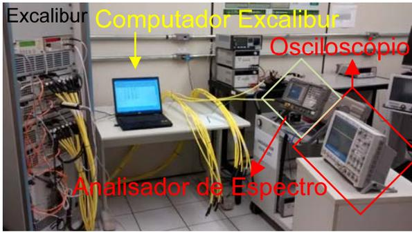
Fig.5. Arranjo experimental usado para medição dos sinais realizada diretamente na saída do gerador de sinais Excalibur RDS.
