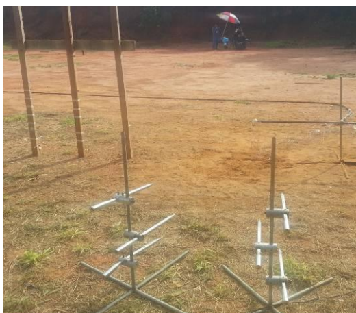
Fig. 4. Setup das configurações "c", "d" e "e". Os sensores de pressão estão posicionados na parte de baixo da imagem, apontando para o explosivo, as estacas ajudam na marcação de distância e a câmera de alta velocidade está posicionada ao fundo.
