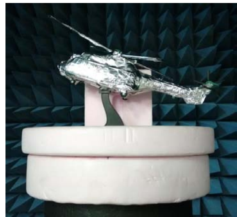
Fig. 10. Modelo plástico coberto com filme metálico em um suporte de poliestireno extrudido no interior da câmara semianecoica.
