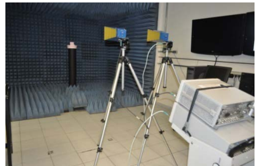
Fig. 9. Câmara semianecoica e equipamentos utilizados nas medidas.
