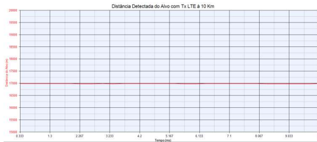
Fig. 19. Distância do alvo detectado com a presença do sinal de comunicação interferente transmitido a 10 km do receptor.
