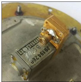
Fig. 4. Adaptação de conector SMA em antena do MAGE do P-95.
