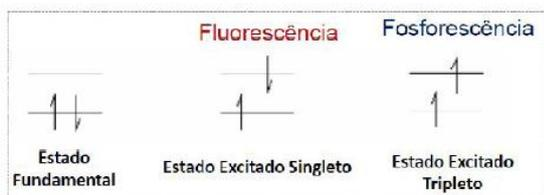
Fig. 3. Diferença dos estados excitados nos fenômenos de fluorescência e fosforescência.
