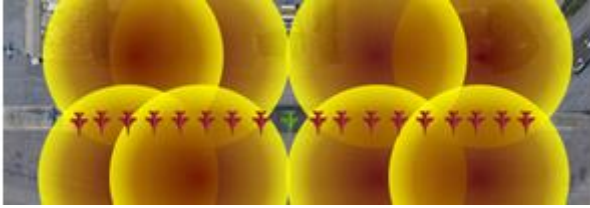
Fig. 7. Exemplo de erro de deflexão superior ao D_{max} em quatro lançamentos de dois armamentos em série cada, perpendicular ao alvo
