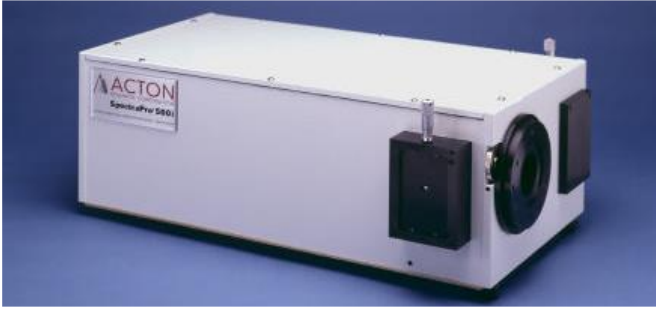
Fig. 3. Monocromador Acton SpectraPro-2500i [9].
