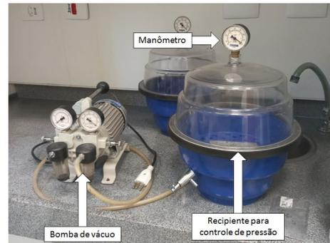
Fig. 2. Sistema de aplicação de vácuo.
